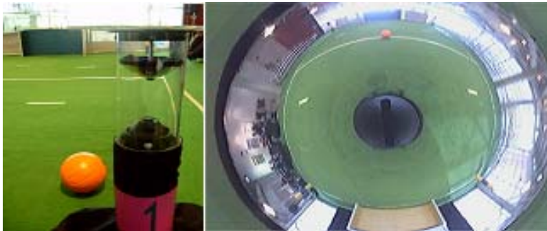
Figure 4 : Système de vision omnidirectionnelle distribué sur chaque robot.
